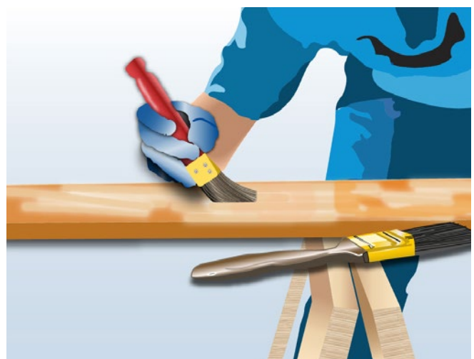
Abb. 12.2 Oberflächenbehandlung eines Werkstücks im Streichverfahren mit einem Pinsel
